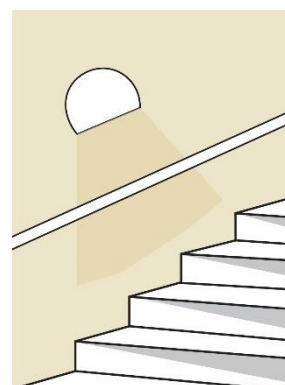
Trappens geometri markeret med sidebelysning.
